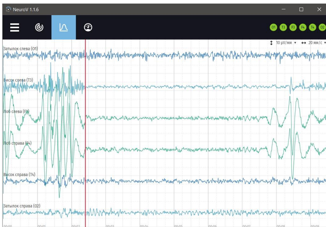
Рис. 10. Биосигналы мозга, включая альфа-активность (в центральной части экрана) и глазодвигательные артефакты (крайне левые и правые части экрана), регистрируемые гарнитурой NeuroForsage. Красная вертикальная черта показывает текущее положение обновления экрана справа-налево.
