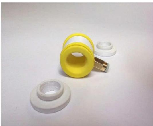
4. Вставьте запасную латексную мембрану внутрь основной части. Затем выворачивая наружу наденьте края мембраны на основную часть.
