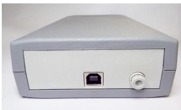
На задней панели основного блока расположены (слева направо): разъём для подключения кабеля USB, быстроразъёмное соединение  $\varnothing 4$  мм для проведения калибровки и тестирования прибора.
