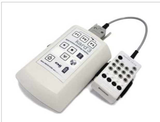
Беспроводной 9-канальный полиграф KARDi3/9, подключение через WiFi
