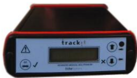
32-канальный амбулаторный ЭЭГ (с автономной регистрацией до 72 часов)
