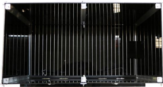
Чёрные стенки, прямоугольная платформа для методики УРПИ Step-down
