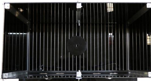
Чёрные стенки, круглая платформа для методики УРПИ Step-down
