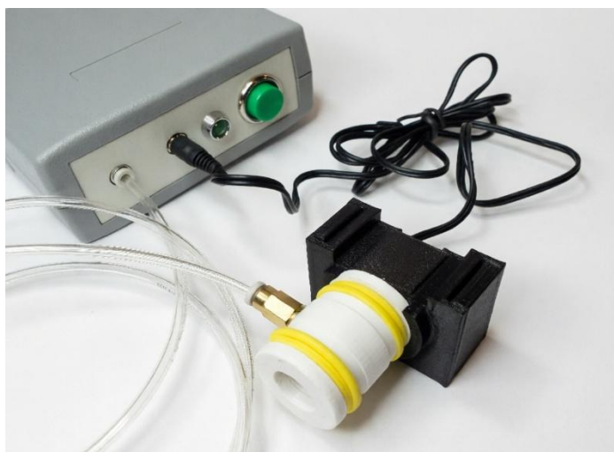
Рис. 1.5.2. Подключение прозрачной трубки к быстроразъёмному соединению
