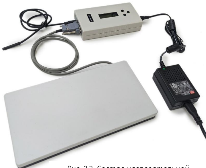
Рис. 2.3. Состав нагревательной платформы «Флогистон»
