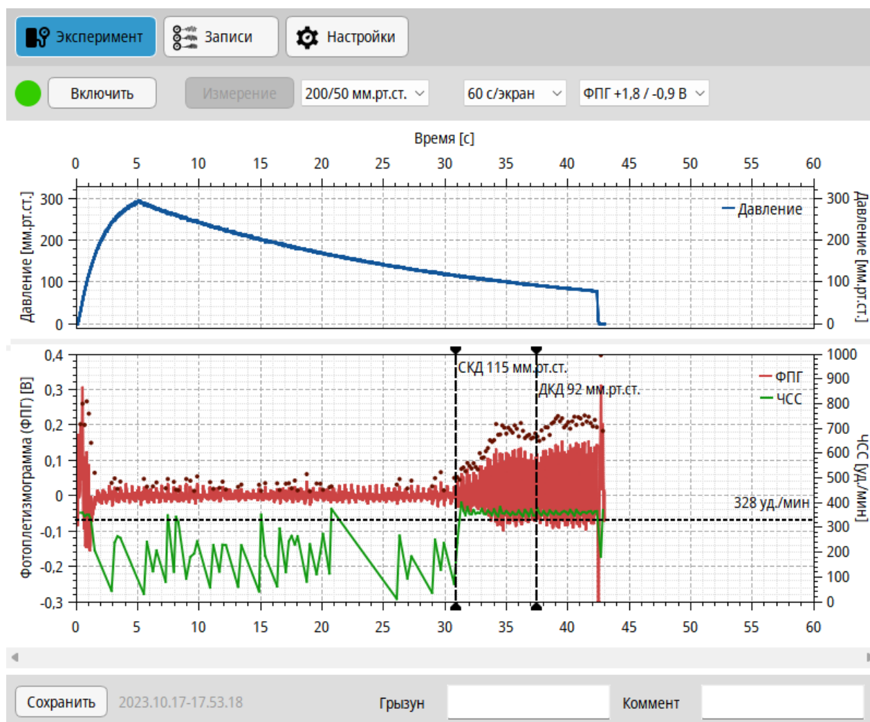
Рис. 1.8.1. Запись эксперимента: кривая давления в манжете; ФПГ с метками СКД и ДКД
