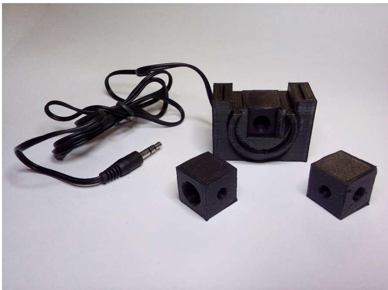
Замена силиконовой вставки в датчике пульса может потребоваться для разных диаметров хвоста крыс или мышей.
