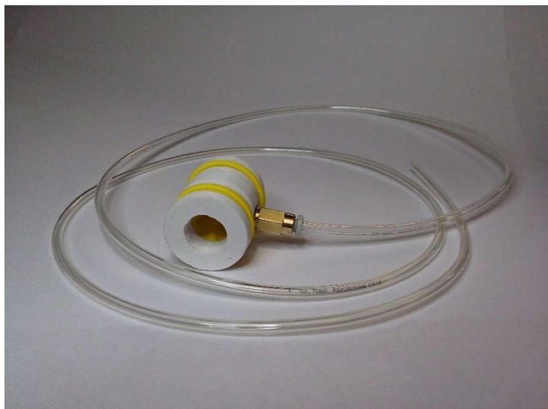
Манжета давления состоит из основной части, 2-х боковых вставок, латексной мембраны и 3-мм прозрачной трубки (длиной 1 метр) для подключения к основному блоку.
