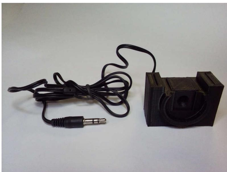
Он состоит из корпуса, в который вставляется силиконовая вставка под нужный диаметр хвоста крысы (мыши) и кабеля (длиной 1 метр).
