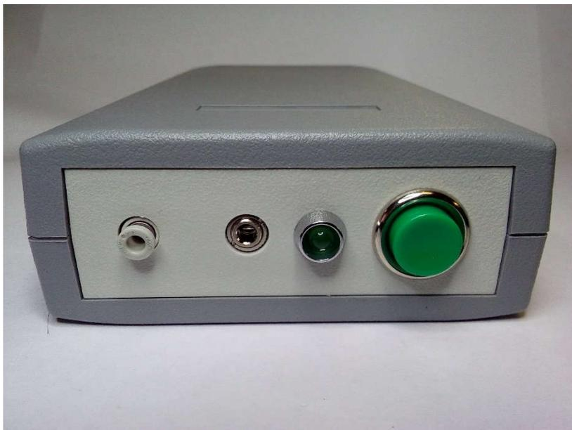
На задней панели основного блока расположены (слева направо): разъем для подключения кабеля USB, 4 мм быстроразъемное соединение для проведения калибровки и тестирования прибора.
